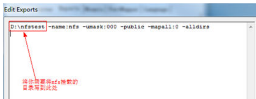
图 4-2 配置共享路径: d:\NFS -name:nfs -umask:000 -public -mapall:0 -alldirs
